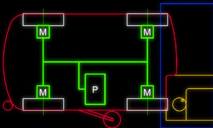
Полноприводная гидростатическая трансмиссия с четырьмя независимыми гидромоторами колес. В отличие от механической трансмиссии, данная трансмиссия обеспечивает постоянную мощность и крутящий момент, а также большую эксплуатационную гибкость.
