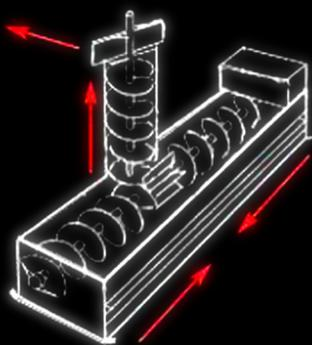
Система подъема снега состоит из двух шнеков. Горизонтальный шнек перемещает снег в центр кондиционера, где расположен вертикальный шнек, который, в свою очередь, поднимает снег в бункер.
